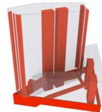
Figure 6: Gebäudevolumen / Kernanordnung und flankierende Rahmen im Turm
